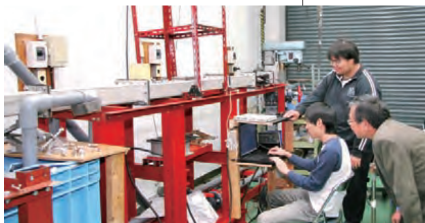
流動振動試験装置で実験
