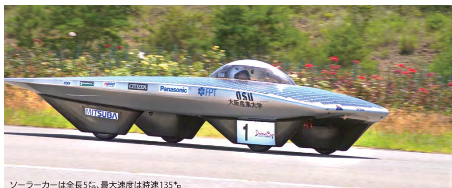
ソーラーカーは全長5m、最大速度は時速135km/h
