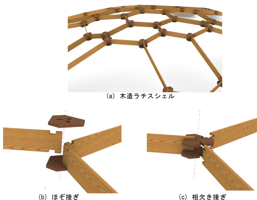
図 4 接合部でねじれが無い EO ラチスシェルの幾何形状を活かしたディテール案
