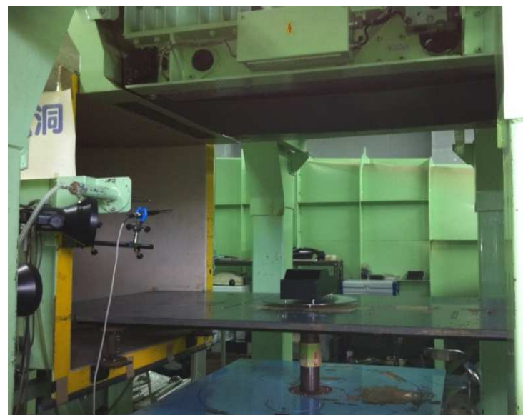
大型風洞による車体の空力測定
